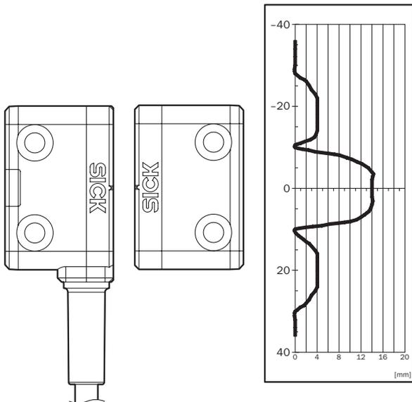
Gesicherter Einschaltabstand  $S_{a0}$  10 mm. Randbereiche bei paralleler Annäherung beachten: Wenn sich der Betätiger seitlich zur Sensorfläche bewegt, muss ein Mindestabstand von 6 mm (typisch) eingehalten werden. Dies verhindert ein zu frühzeitiges Auslösen aufgrund der seitlichen Ansatzbereiche.
